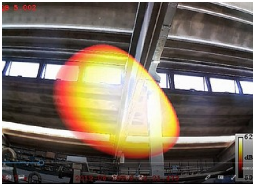
Esempio di analisi con antenna microfonica (“olografia acustica”) per l’individuazione della provenienza del suono.
